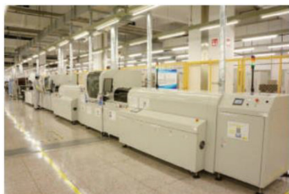
Станция сборки печатных плат
